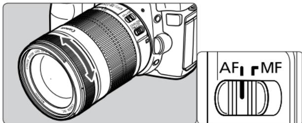
Zum Fotografieren mit automatischer Scharfeinstellung (AF) stellen Sie den Fokus-Wahlschalter auf AF (Autofokus-Modus). Für ausschließlich manuelle Scharfeinstellung (MF) stellen Sie den Fokus-Wahlschalter auf MF und fokussieren mit dem Scharfstellung.
