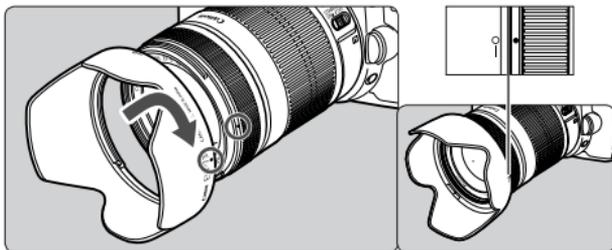
Die Gegenlichtblende EW-73B verhindert unerwünschten Lichteinfall. Sie schützt die Frontlinse außerdem vor Regen, Schnee und Staub. Zum Aufsetzen fluchten Sie zunächst die Ansetzmarkierung der Gegenlichtblende mit dem roten Punkt vorn am Objektiv. Drehen Sie dann die Blende in Pfeilrichtung, bis sich der rote Punkt am Objektiv mit der Anschlagmarkierung der Gegenlichtblende deckt. Zur Aufbewahrung lässt sich die Gegenlichtblende umgekehrt ausgerichtet auf das Objektiv aufsetzen.
