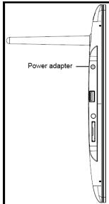
Pripojte dodaný **sietový diel** k digitálnemu fotorámkiku (**DC-IN**). Druhý koniec **sietového dieľu** zapojte do elektrickej **zásvky**. Digitálny fotorámik sa teraz automaticky zapne. Krátkym stlačením tlačidla **power** vypnete alebo opäťovne zapnete digitálny fotorámik.
