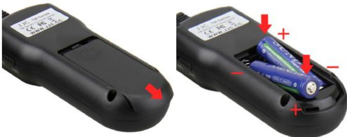
2. Der Deckel ist leicht zurückzuschieben, dabei wird die Montage der Batterien beendet.
