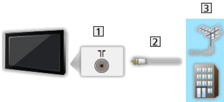
1 Anschluss für terrestrische Antenne / Kabel
