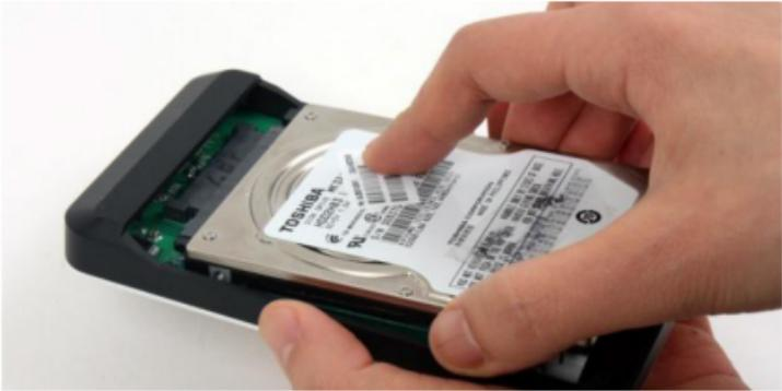
③ Cerrar la tapa inferior empujándola hacia arriba de acuerdo con la dirección de la flecha. El ZM-SHE350 permite la instalación del disco duro sin necesidad de tornillos.
