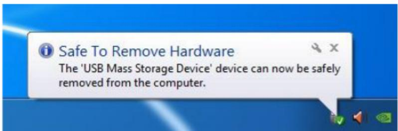
ZM-SHE350具有智能安装和卸载功能，移除设备简单、容易且安全。按下“MENU”键2秒以上，HDD将自动断开连接。运行方式类似于[安全删除硬件]。为了使用该功能，使用时电脑和ZM-SHE350之间应不存在数据传输。
