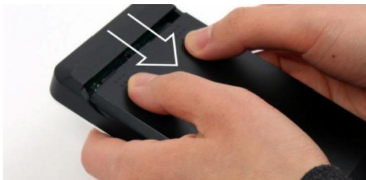
② Installieren Sie ein 2.5" SATA HDD wie im Bild dargestellt.
