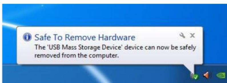
ZM-SHE350 posiada inteligentną funkcję MONTOWANIA i ODMONTOWANIA pozwalającą na łatwe, wygodne i bezpieczne usuwanie sprzętu. Należy przytrzymać przycisk "MENU" przez ponad 2 sekundy a HDD zostanie automatycznie odłączony. Zasada działania tej funkcji jest podobna do [Bezpiecznego usuwania sprzętu] \* Aby przeprowadzić tę operację, pomiędzy urządzeniem a komputerem nie powinien trwać przesył danych.
