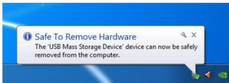
ZM-SHE350 はシンプル、便利で安全なハードウェアの取り外しを行うために、スマートマウントとアンマウント機能をサポートしています。「メニュー」ボタンを2秒以上押すとHDDが自動的に取り外されます。これは[ハードウェアの安全な取り外し]のように機能します。\*この機能を実行するには、その時点でパソコンとZM-SHE350の間でデータ転送を行なうことはできません。ここでも「メニュー」ボタンを2秒以上押すとHDDが自動的に接続されます。ユーザーは実行するために、再度正しいパスワードを入力する必要があります。
