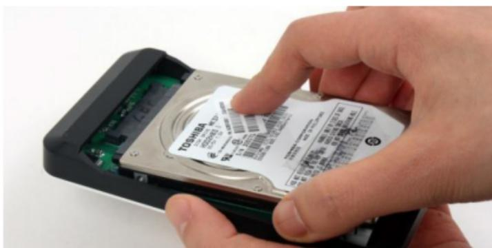
③ Feche o painel de volta, empurrando-se de acordo com a direção da seta. SHE350 suporta a instalação de HDD sem parafusos.
