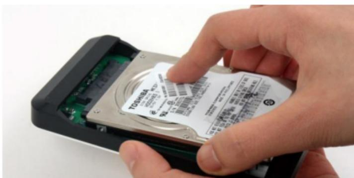
③ Chiudere il pannello posteriore premendo verso l'alto in base alla direzione della freccia. SHE350 supporta un'installazione HDD senza viti.
