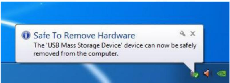
ZM-SHE350 suporta "Smart" Montar e Desmontar, para que a remoção de hardware seja simples, conveniente e seguro. Carrega o botão "MENU" durante 2 segundos, em seguida, o HDD é automaticamente desligado. Funciona como [Remover hardware com segurança].
