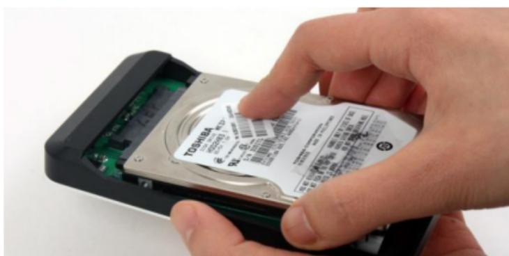
③按照箭头方向向上推动后盖将其关闭。SHE350支持无螺丝HDD安装。
