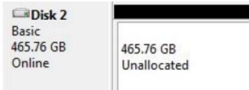
⑥ Désormais, vous pouvez commencer les processus de partitionnement et de formatage sur le disque dur. Faites un clic droit sur les détails de l'espace du pilote (image ci-dessous) et sélectionnez « Nouveau volume simple ... » ou « Nouvelle partition... ».
