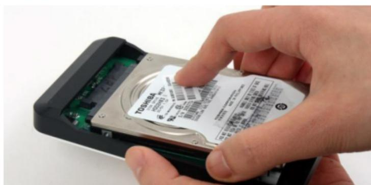
③ Schieben Sie den hinteren Deckel in die Pfeilrichtung(s.Bild) um es zu schließen. SHE350 unterstützt eine schraubenlose HDD Installation.
