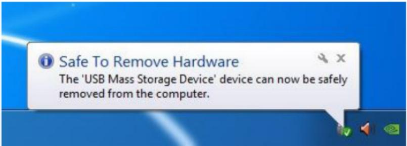
ZM-SHE350 unterstützt "Smart MOUNT/ UN-MOUNT" Funktionen um einfache und sichere Hardware-Entfernung zu ermöglichen. Drücken Sie die "MENU"-Taste mehr als 2 Sekunden, dann wird die Festplatte automatisch entfernt, wie bei der Funktion [Hardware sicher entfernen]. \* Um diese Funktion auszuführen, soll es keine Datenübertragung zwischen PC und ZM-SHE350 zu diesem Zeitpunkt bestehen
