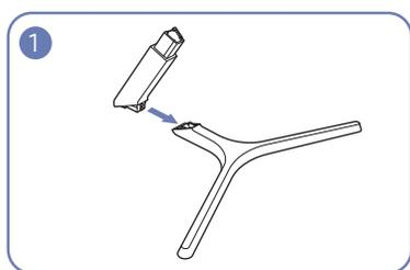
Setzen Sie den Standfußanschluss in der Richtung in den Standfuß, die in der Abbildung gezeigt ist. Vergewissern Sie sich, dass der Standfußanschluss fest verbunden ist.
