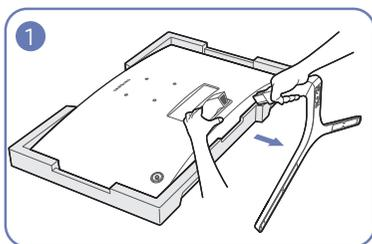
Legen Sie den Styroporrahmen aus der Packung auf den Boden und legen Sie das Gerät mit der Vorderseite nach unten wie abgebildet auf den Styroporrahmen.
