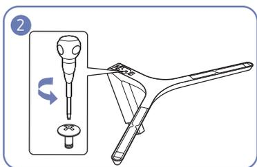
Drehen Sie die Befestigungsschraube unten am Standfuß, um sie zu lösen.
