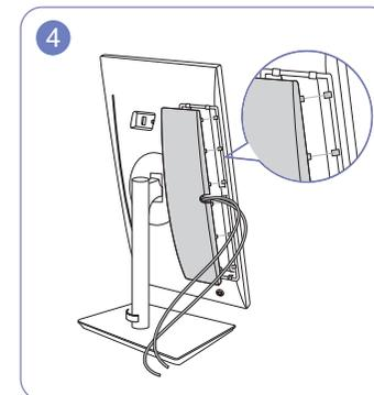
4 Ordnen Sie die Kabel durch die Rille an der HINTEREN ABDECKUNG und befestigen Sie dann die HINTERE ABDECKUNG. Bitte stecken Sie bei der Befestigung der HINTEREN UNTEREN ABDECKUNG zuerst sechs Stäbe HINTEREN UNTEREN ABDECKUNG in die unteren Löcher an der HINTEREN ABDECKUNG.
