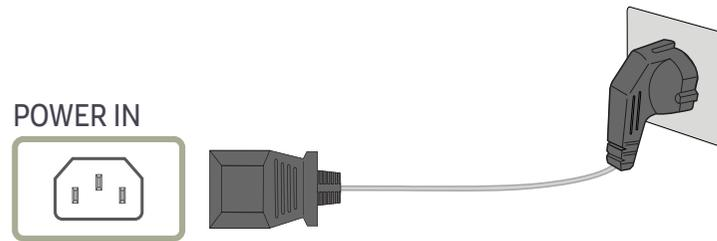
Um dieses Gerät zu verwenden, verbinden Sie das Netzkabel mit einer Steckdose und dem Anschluss **POWER IN** des Geräts.
