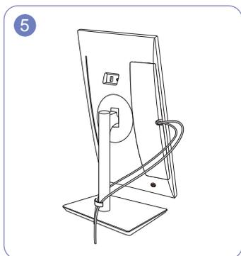
5 Führen Sie jedes der beiden Kabel wie in der Abbildung gezeigt durch eine Seite der KABEL-STANDFUSS-HALTERUNG.
