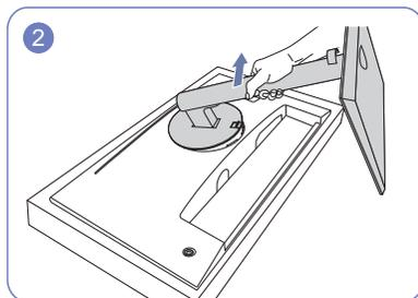
Heben Sie die Halterung für den Standfuß in Pfeilrichtung an, um sie vom Display abzunehmen.
