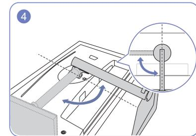
Drehen Sie die Halterung für den Standfuß der Anzeige um 90° im Uhrzeigersinn, um sicherzustellen, dass die Halterung für den Standfuß der Anzeige befestigt ist.
