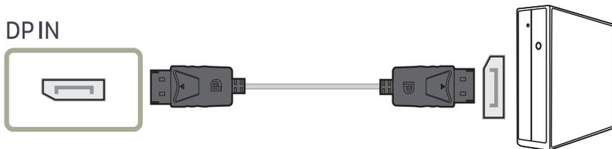
— Verwenden Sie für eine Anzeige mit 2560 x 1440 bei 60 Hz ein DP-Kabel, das 2560 x 1440 bei 60 Hz unterstützt. Achten Sie darauf, dass die Grafikkarte der DP-Quelle die Auflösung 2560 x 1440 bei 60 Hz unterstützt.
