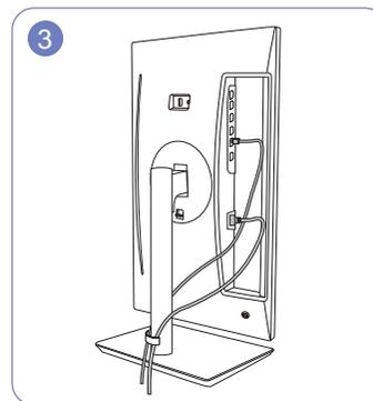
Schließen Sie die Kabel an ihre entsprechenden Anschlüsse an und führen Sie dann jedes der beiden Kabel wie in der Abbildung gezeigt durch eine Seite der KABEL-STANDFUSS-HALTERUNG.
