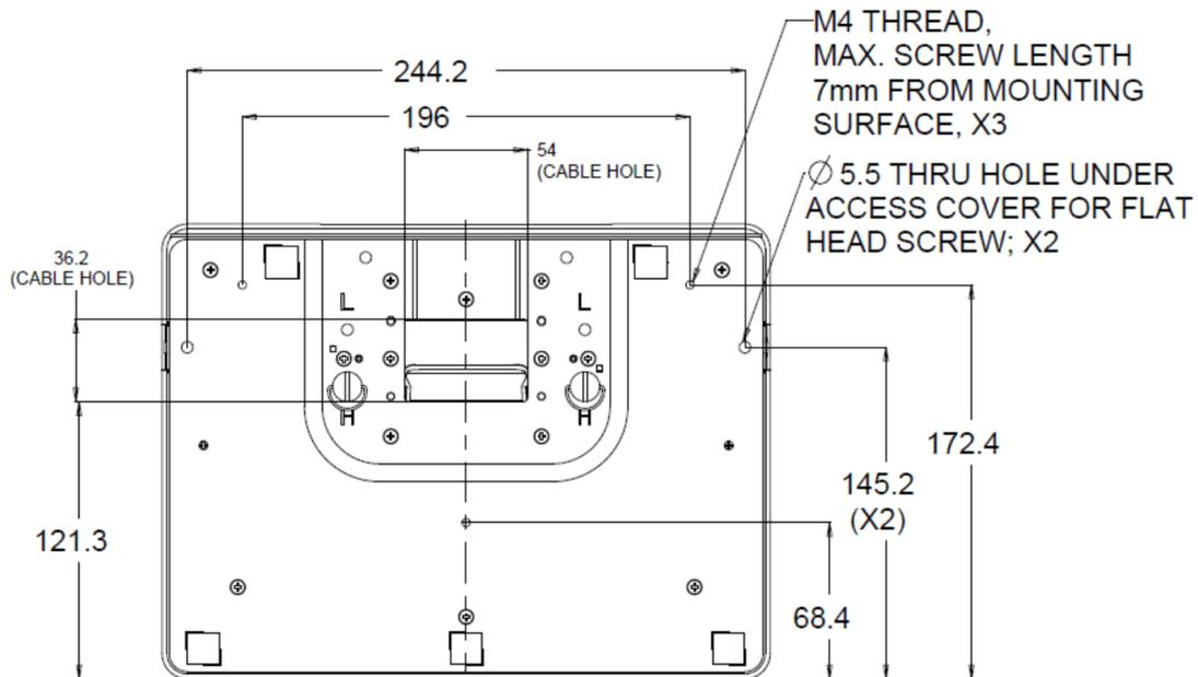
Beim 2002L-Touchmonitor werden an der Unterseite der Basis zur Montage und Befestigung Durchgangslöcher mit Gewinde bereitgestellt.
