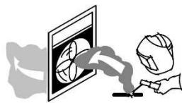
**Rezacie a pilotný oblúk je zdrojom veľmi intenzívneho svetelného (najmä UV) žiarenia. Toto žiarenie môže značne poškodiť zrak a pokožku!**
