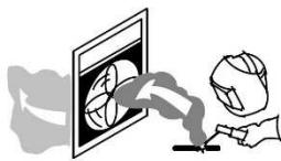
**Řezací a pilotní oblouk je zdrojem velmi intenzivního světelného (zejména UV) záření. Toto záření může značně poškodit zrak a pokožku!**
