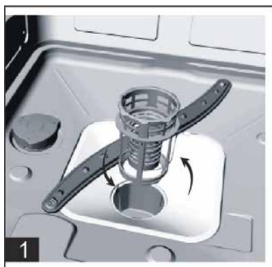
Krok 1: Otočte filtrom proti smeru chodu hodinových ručičiek a potom ho vysuňte.
