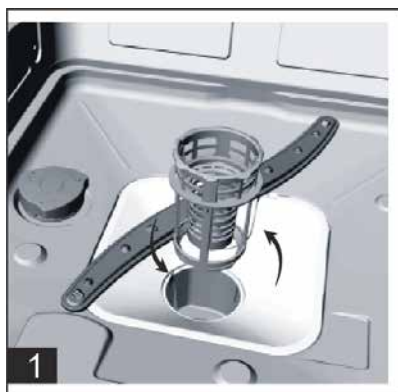
Krok 1: Otočte filtrem proti směru hodinových ručiček a pak jej vysuňte.
