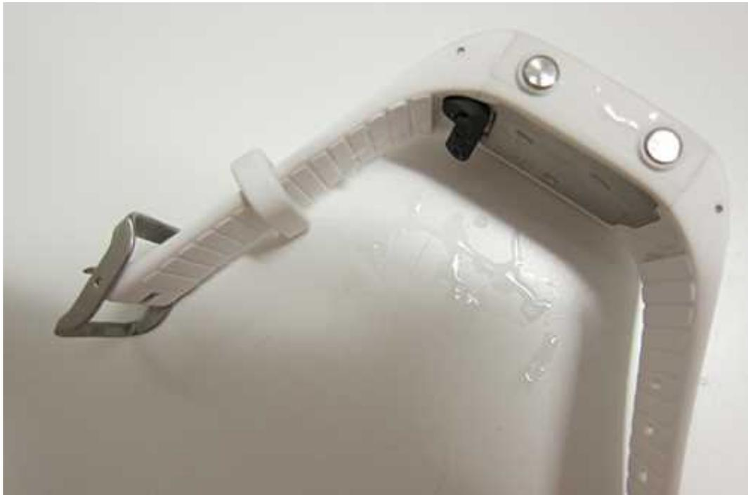
Wenn du den USB-Anschluss verwendest, stelle sicher, dass die Dichtungsfläche der Abdeckung frei von Feuchtigkeit, Haaren, Staub und Schmutz ist. Wische Verschmutzungen vorsichtig ab. Haare, Staub und
