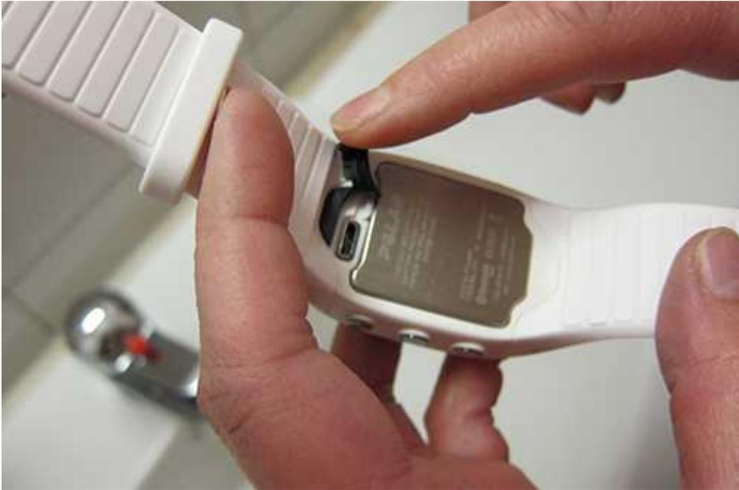
2. Spüle den USB-Anschluss mit lauwarmem Leitungswasser ab. Der USB-Anschluss selbst ist wasserbeständig und du kannst ihn unter laufendem Wasser abspülen, ohne die elektronischen Komponenten zu beschädigen.
