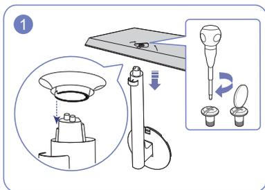
Setzen Sie den Standfußanschluss in der Richtung in den Standfuß, die in der Abbildung gezeigt ist. Drehen Sie die Befestigungsschraube unten am Standfuß bis zum Anschlag, damit er sicher befestigt ist.
