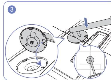
Platzieren Sie die Halterung für den Standfuß wie in der Abbildung gezeigt auf dem Display. Achten Sie beim Platzieren der Halterung für den Standfuß darauf, dass der erhöhte Teil an dem Display in die Rille der Halterung für den Standfuß eingesetzt werden kann.
