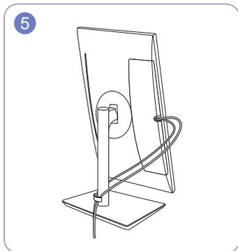
Führen Sie jedes der beiden Kabel wie in der Abbildung gezeigt durch eine Seite der KABELSTANDFUSS-HALTERUNG.
