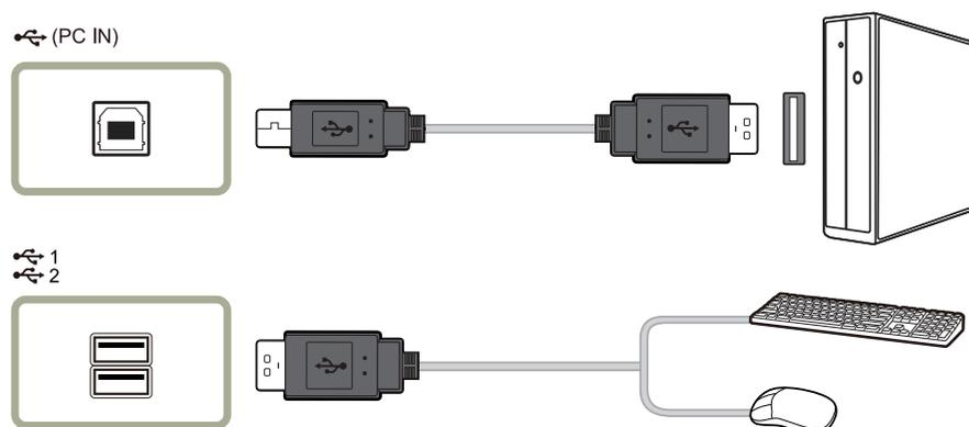
1 Verbinden Sie den
