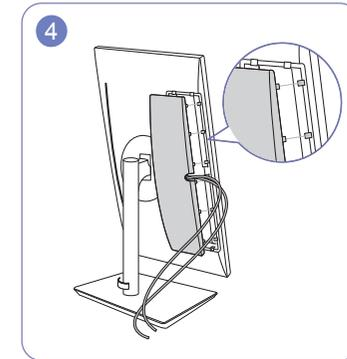
Führen Sie die Kabel durch die Rille auf der HINTEREN NEBENABDECKUNG und bringen Sie die HINTERE NEBENABDECKUNG an. Richten Sie beim Anbringen der HINTEREN NEBENABDECKUNG zuerst sechs Lamellen der HINTEREN NEBENABDECKUNG nach den unteren Öffnungen der HINTEREN ABDECKUNG aus.
