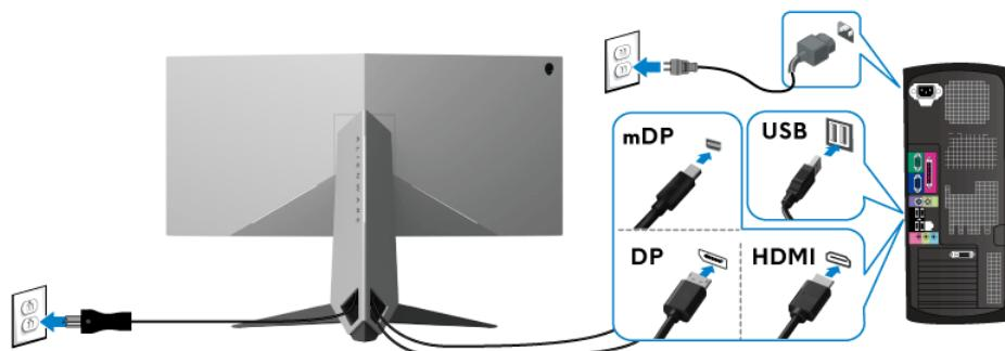
1. Zapojte druhý konec připojeného kabelu DisplayPort (nebo Mini-DisplayPort na DisplayPort) nebo HDMI do svého počítače.
