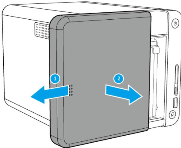
**6. Entfernen Sie die Gehäuseabdeckung.**
