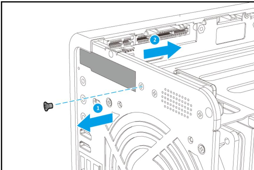
8. Optional: Montieren Sie die QNAP-Halterung an der Erweiterungskarte.
