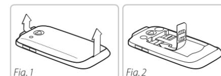
**Fig. 1:** Akku-Deckel entfernen
