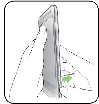
3. Hebeln Sie die Abdeckung lose und ziehen Sie sie ab.
