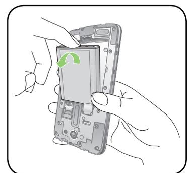
5. Stecken Sie die Micro-SIM-Karte in der Micro-SIM-Steckplätze und legen dann den Akku wieder ein und die hintere Abdeckung an.
