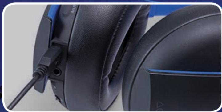
Laden Sie das Headset auf, indem Sie es über ein USB-Kabel an einen USB-Anschluss anschließen. Es kann bis zu 3 Stunden dauern, bis das Headset vollständig aufgeladen ist.
