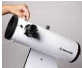
Távolítsa el a két darab, kézzel állítható csavart az optikai tubusból.
