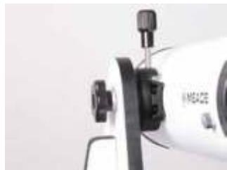
Lazítsa meg egy kissé a fecskefarkú illesztésű szorítógombot, majd csúsztassa az optikai tubust a fecskefarkú illesztésű fogadóegységen addig, amíg a teleszkóp megtartja az éppen aktuális helyzetét anélkül, hogy felfelé vagy lefelé csúszkálna a függőleges tengelyen.
