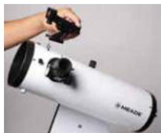
Pomocí dvou křídlatých matic upevněte hledáček s červeným terčem na optický tubus. Utáhněte napevno, ale s citem.
