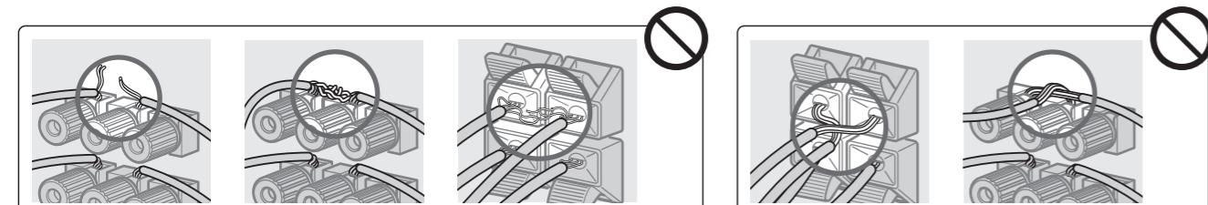
De gestripte luidsprekerkabels zijn niet stevig in elkaar gedraaid en niet volledig in de luidsprekeraansluitingen gestoken.
