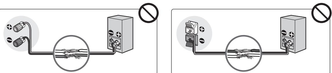
Verbind niet twee luidsprekerkabels om de kabel te verlengen.
