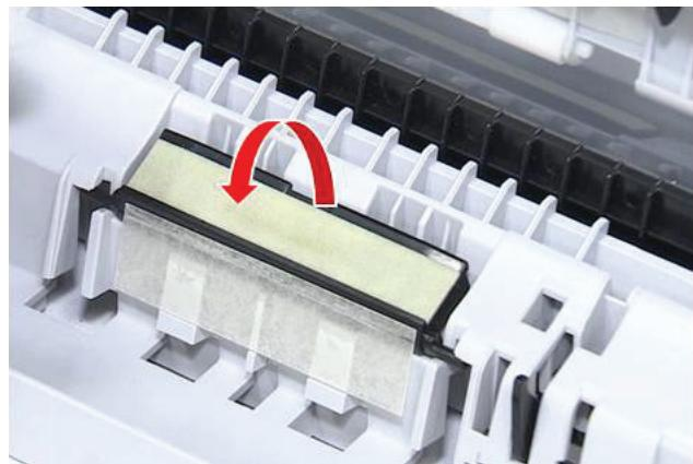
**SK** Potiahnite a uvoľnite trecí segment MP.
