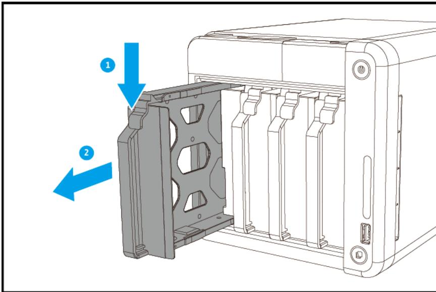
4. Installieren Sie ein Laufwerk im Laufwerkeinsatz.
