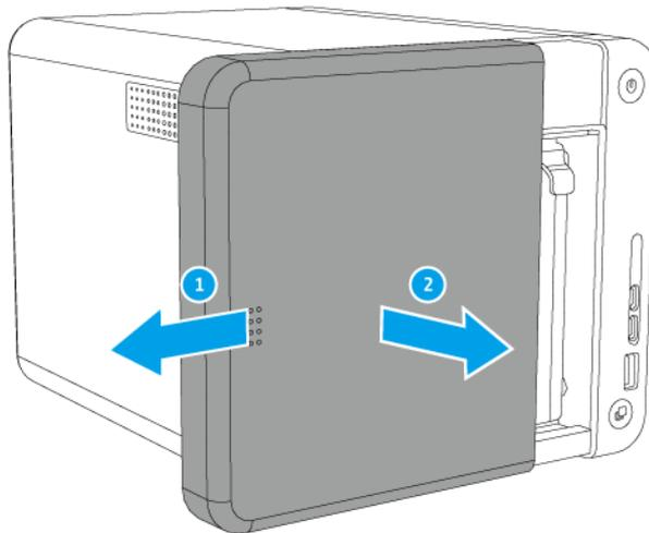
**6. Entfernen Sie die Gehäuseabdeckung.**
