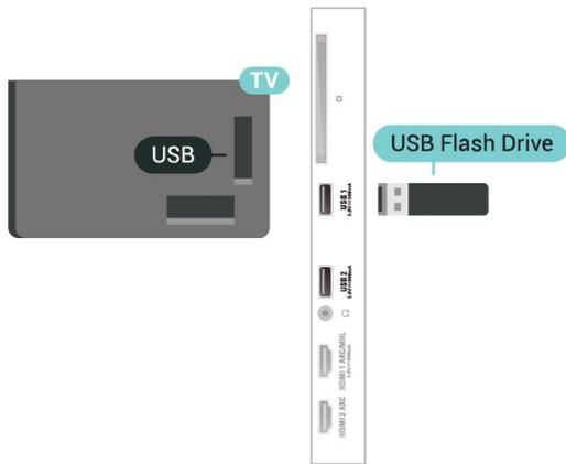
Der Fernseher erkennt das Flashlaufwerk und öffnet eine Liste mit dessen Inhalten. Wenn die Inhaltsliste nicht automatisch angezeigt wird, drücken Sie **SOURCES**, und wählen Sie **USB**.
