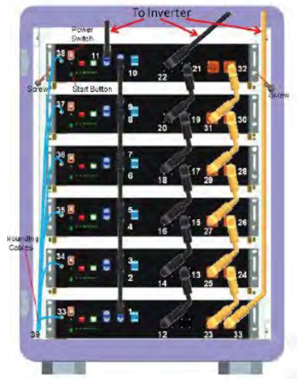
Obr. 11 – Ukázka zapojení bateriového banku – bod 4–5
