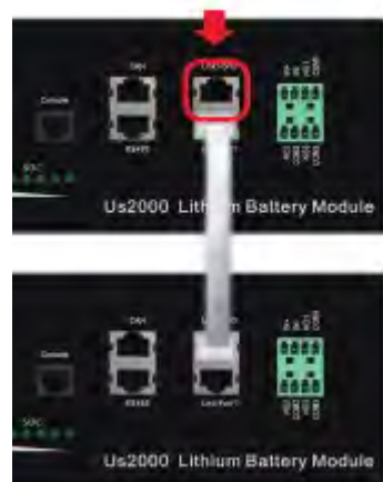
Obr. 12 – Ukázka zapojení bateriového banku – bod 6–7
