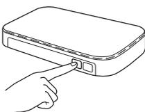
Diese Funktion ermittelt automatisch, welches Verfahren (WPS oder AOSS™) Ihr Wireless Access Point/Router zur Konfiguration Ihres Gerätes verwendet.
