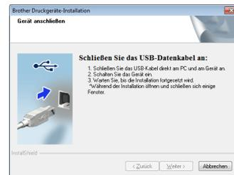
**e** Schließen Sie das USB-Kabel am USB-Anschluss des Gerätes an, das durch ein Symbol
