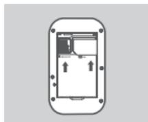
3. Schieben Sie den SIM-Kartenrahmen nach rechts und heben Sie ihn an. Legen Sie, wie gezeigt, die SIM/UICC-Karte mit den goldfarbenen Kontakten nach unten in den SIM/UICC-Karteneinschub ein. Setzen Sie den Rahmen wieder ein und schieben Sie ihn nach links in seine Position.
