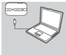
1. Conecte el DWR-932 al PC con el cable USB. Siga las instrucciones en pantalla del controlador.
