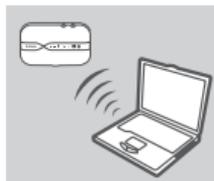
1. Utilizați adaptorul wireless al PC-ului pentru conectarea la rețeaua wireless **dlink\_DWR-932\_xxxx**. Numele rețelei wireless (SSID) și parola sunt imprimate pe eticheta aflată pe capacul bateriei.
