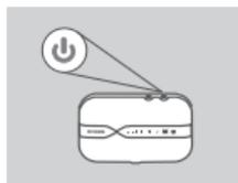
6. Tryck och håll kvar på strömknappen i fyra sekunder för att slå på enheten. När lysdioden för ström ändras från grönt till fast blått eller orange sken kan du fortsätta med konfigurationen.
