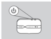
6. Naciśnij przycisk zasilania i przytrzymaj go przez trzy sekundy, aby włączyć urządzenie. Kiedy dioda LED zasilania zmieni kolor światła z zielonego na ciągle niebieskie lub bursztynowe, można przystąpić do konfiguracji.
