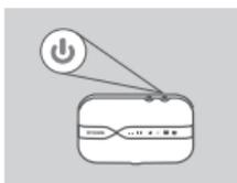
6. Pulse y mantenga presionado el botón de alimentación durante tres segundos para encender el dispositivo. Una vez que el LED de alimentación cambie de verde a azul o ámbar continuo, podrá pasar a la configuración.
