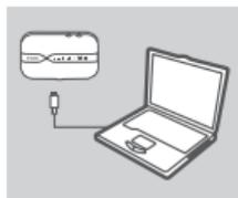
1. Collegare il DWR-932 al PC mediante il cavo USB. Attenersi a tutte le istruzioni visualizzate sullo schermo.
