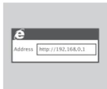
2. Anvend en web-browser til at gå til **192.168.0.1** for at logge ind til routerens konfigurationsinterface. Standard-brugernavnet er **admin**, og kodeordet efterlades tomt.
