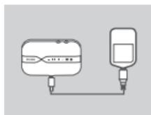
5. Connectez l'extrémité micro USB du câble USB sur le port micro USB, en bas du DWR-932 et branchez l'extrémité USB sur le port USB d'un adaptateur d'alimentation ( non fournie) ou sur un PC pour recharger la batterie.
