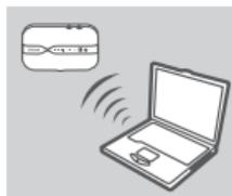
1. Utilize o adaptador sem fios do seu computador para ligar à rede sem fios **dlink\_DWR-932\_xxxx**. O nome da rede sem fios (SSID) e a palavra-passe estão impressos na etiqueta na tampa da bateria.
