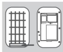
2. Az SSID-t (a hálózat nevét) és jelszavát megtalálja az akkumulátor fedelén lévő címkére nyomtatva. Ha vezeték nélkül szeretne csatlakozni a DWR-932-höz, meg kell adnia ezt az SSID-t és jelszót.
