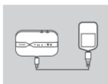
5. Pentru a încărca bateria, conectați capătul Micro USB al cablului Micro USB în portul de Micro USB din partea de jos a DWR-932 și introduceți capătul USB în portul USB al încărcătorului (nu este inclus) sau la un PC.
