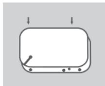
4. Plaats de accu terug en sluit het klepje van de accuhouder;
