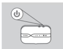
6. Tryk og hold på strømknappen i tre sekunder for at tænde for enheden. Når spændings-LED-ikonet ændrer sig fra grønt til fast blått eller gult, kan du fortsætte med konfigurationen.
