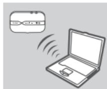
1. Verwenden Sie den Drahtlosadapter Ihres PCs, um sich mit dem **dlink\_DWR-932\_xxxx** WLAN-Netzwerk zu verbinden. Der WLAN-Netzwerkname (SSID) und das Kennwort sind auf dem Etikett auf der Batterieabdeckung aufgedruckt.
