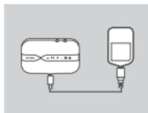
5. Ligue a extremidade Micro USB do cabo USB à porta Micro USB no fundo do DWR-932 e ligue a extremidade com a ficha USB na porta USB de um adaptador de corrente (não incluído) ou a um PC para carregar a bateria.
