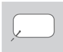
1. Fjern batteridækslet bag på enheden ved forsigtigt at skubbe det op fra boksen med hjørnefligen og så fjerne batteriet.
