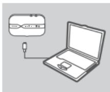
1. Priključite DWR-932 v vaš računalnik s pomočjo kabla USB. Sledite vsem zaslonskim povzivom za gonilnik.
