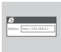
2. Utilisez un navigateur Web pour accéder à **192.168.0.1** pour vous connecter à l'interface de configuration du routeur. Le nom d'utilisateur par défaut est **admin** et le mot de passe doit rester vierge.
