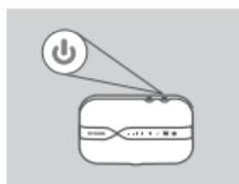
6. Pritisnite in štiri sekund držite gumb za vklop/izklop, da vklopite napravo. Ko LED napajanja preneha svetiti z zeleno in zasveti z modro ali škrlatno, lahko nadaljujete s konfiguracijo.
