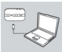
1. Podłącz router DWR-932 do komputera za pomocą kabla USB. Postępuj zgodnie z instrukcjami wyświetlanymi na ekranie.
