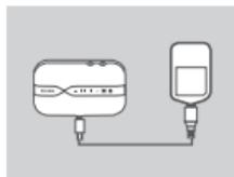
5. Tilslut Mikro USB-enden på USB-kablet ind i Mikro USB-porten nederst på DWR-932, og sæt USB-enden i USB-porten på en strømadapter (medfølger ikke) eller en PC for at oplade batteriet.
