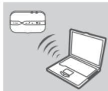
1. Utilice el adaptador inalámbrico del PC para conectarse a la red inalámbrica de **dlink\_DWR-932\_xxxx**. El nombre (SSID) y la contraseña de la red inalámbrica están impresos en la etiqueta ubicada en la cubierta de la batería.
