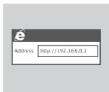
2. Använd en webbläsare för att gå till **192.168.0.1** för att logga in på routerns konfigurationsgränssnitt. Standardanvändarnamnet är **admin** och lösenordet lämnas tomt.
