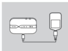
5. Dugja az USB-kábel mikro-USB végét az DWR-932 alján található mikro-USB-portba, majd dugja a normál USB-végét a (külön beszerezhető) tápadapter vagy számítógép USB-portjába az akkumulátor töltéséhez.
