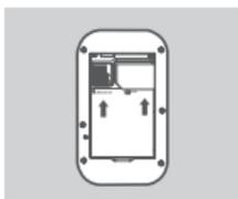
3. Deslice el marco de la tarjeta SIM a la derecha y levántelo. Introduzca la tarjeta SIM/UICC en la bahía para tarjetas SIM/UICC como se muestra, asegurándose de que los contactos dorados están hacia abajo. Vuelva a colocar el marco y deslícelo hacia la izquierda para bloquearlo en su posición.
