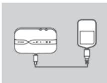
5. Conecte el extremo Micro USB del cable USB al puerto Micro USB de la parte inferior del DWR-932 y enchufe el extremo USB en el puerto USB de un adaptador de alimentación (no incluido) o de un PC para cargar la batería.
