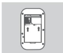
3. Skyv SIM-kortrammen til høyre og løft det opp. Sett inn SIM/UICC-kortet i SIM/UICC-kortsporet som vist, med de gullfargede kontaktene vendt nedover. Sett på plass rammen og skyv det til venstre til den er i riktig posisjon.
