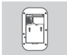
3. Faites glisser le cadre de la carte SIM vers la droite et soulevez-le. Insérez la carte SIM/UICC dans la fente correspondante, comme illustré, en veillant à ce que les contacts dorés pointent vers le bas. Remettez le cadre en place et faites-le glisser vers la gauche pour le verrouiller en position.
