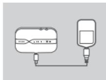
5. Kytke USB-kaapelin Micro USB -pää Micro USB -porttiin DWR-932:n pohjassa ja kytke USB-pää virtasovittimen tai tietokoneen USB-porttiin akun lataamiseksi.
