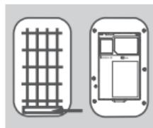
2. Note que o SSID (nome da rede sem fios) e a palavra-passe estão impressos na etiqueta na tampa da bateria. Se pretende ligar ao DWR-932 através de uma rede sem fios, é necessário que introduza este SSID e a palavra-passe.
