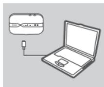
1. Συνδέστε το DWR-932 στον υπολογιστή σας χρησιμοποιώντας το καλώδιο USB. Ακολουθήστε οποιεσδήποτε προτροπές του προγράμματος οδήγησης εμφανιστούν στην οθόνη.
