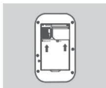
3. Potisnite okvir kartice SIM v desno in ga dvignite. Vstavite kartico SIM/UICC v režo za kartico SIM/UICC, kot je prikazano. Ob tem pazite, da so zlati kontakti obrnjeni navzdol. Ponovno namestite okvir in ga potisnite v levo, da ga zaklenete v položaj.
