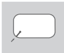
1. Sejměte kryt baterie ze zadní strany zařízení jemným vyloupnutím z pláště pomocí drážky v rohu. Poté vyjměte baterii.
