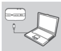
1. Koble DWR-932 til PC-en med USB-kabelen. Følg driverinstruksjonene på skjermen.
