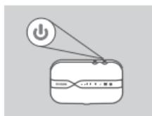
6. Premere e tenere premuto il pulsante di accensione per tre secondi per accendere il dispositivo. Quando il colore del LED cambia da verde a blu fisso o ambrato, è possibile procedere con la configurazione.
