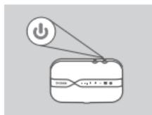
6. Stisknutím a podržením tlačítka napájení po dobu čtyř sekund zařízení zapnete. Jakmile se LED kontrolka změní ze zelené na modrou nebo oranžovou, můžete pokračovat v konfiguraci.
