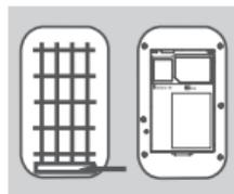
2. Název bezdrátové sítě (SSID) a heslo jsou vytištěné na štítku pod krytem baterie. Pokud chcete připojit zařízení DWR-932 bezdrátově, budete muset zadat tento název SSID a heslo.
