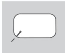
1. Entfernen Sie die Batterieabdeckung auf der Rückseite des Gerätes, indem Sie diese mit den Aussparungen in der Ecke nach oben aus dem Gehäuse drücken. Entnehmen Sie dann die Batterie.
