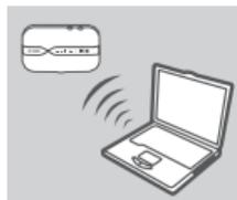
1. Utilisez l'adaptateur sans fil de votre PC pour vous connecter au réseau sans fil **dlink\_DWR-932\_XXXX**. Le nom de ce réseau sans fil (SSID) et le mot de passe sont imprimés sur l'étiquette sur le couvercle de la batterie.
