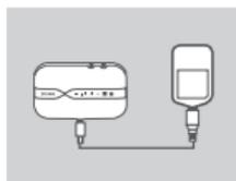
5. Koble Micro USB-enden av USB-kabelen til Micro USB-porten nederst på DWR-932 og sett USB-enden inn i USB-porten på en strømadapter (ikke inkludert) eller en PC for å lade batteriet.
