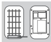
2. Bemærk SSID'en (netværksnavnet) og adgangskoden på etiketten på batteridækslet. Hvis du vil oprette forbindelse til DWR-932 trådløst, skal du indtaste denne SSID og adgangskoden.
