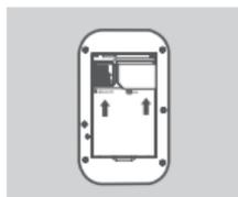
3. Posuňte rámeček karty SIM doprava a zvedněte. Vložte kartu SIM/UICC do slotu pro kartu SIM/UICC tak, jak je uvedeno na obrázku. Ujistěte se, zda zlaté kontaktní plochy míří směrem dolů. Rámeček vyměňte a posunutím doleva jej uzamkněte v poloze.
