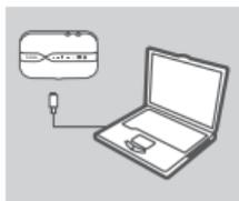
1. Tilslut DWR-932 til din PC med USB-kablet. Følg alle skærmdriverprompterne.
