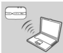
1. Za pomocą karty sieci bezprzewodowej w komputerze połącz się z bezprzewodową siecią **dlink\_DWR-932\_xxxx**. Nazwa sieci bezprzewodowej (SSID) i hasło są wydrukowane na etykiecie na pokrywie baterii.
