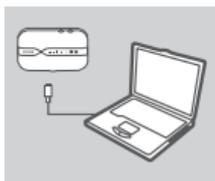
1. Anslut DWR-932 till din dator med USB-kabeln. Följ alla uppmaningar för drivrutinen på skärmen.
