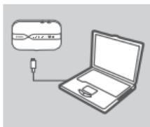
1. Priključite DWR-932 na računalo pomoću USB kabela. Pratite sve upute koje upravljački program prikaže na zaslonu.
