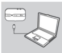
1. Conectați DWR-932 la PC-ul dvs. folosind cablul USB. Respectați instrucțiunile care apar pe ecran.
