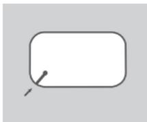
1. Retire la cubierta de la batería en la parte posterior del dispositivo haciendo palanca hacia arriba desde la carcasa utilizando la muesca de la esquina y, a continuación, extraiga la batería.
