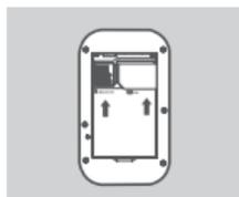
3. Liu'uta SIM-kortin kehys oikealle ja nosta se ylös. Aseta SIM/UICC-kortti SIM/UICC-korttipaikkaan kuten kuvassa varmistaen, että kultakontaktit ovat alaspäin. Vaihda kehys ja lukitse se paikoilleen liu'uttamalla sitä vasemmalle.
