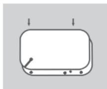
4. Sett inn batteriet igjen og sett på plass batteridekselet.
