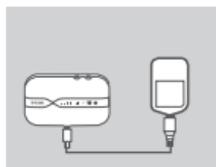
5. Připojte konec Micro USB kabelu USB k portu Micro USB na spodní straně zařízení DWR-932 a zapojte konec USB do portu USB napájecího adaptéru (není součástí balení) nebo počítače, čímž baterii dobijete.
