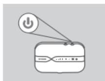
6. Pentru a porni dispozitivul, țineți apăsat pe butonul de pornire timp de trei secunde. Puteți începe configurarea atunci când LED-ul de alimentare se face albastru sau portocaliu constant.
