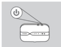
6. Drücken Sie auf die Netztaste und halten Sie sie 3 Sekunden lang gedrückt, um das Gerät einzuschalten. Sobald die Power-LED von grün zu dauerhaft blau oder gelb wechselt, können Sie mit der Konfiguration fortfahren.
