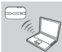
1. Pomocí bezdrátového adaptéru počítače se připojte k bezdrátové síti **dlink\_DWR-932\_xxxx**. Název bezdrátové sítě (SSID) a heslo jsou vytištěné na štítku pod krytem baterie.
