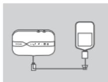
5. Podłącz wtyczkę mikro USB do portu mikro USB u dołu routera DWR-932; podłącz wtyczkę USB do portu USB zasilacza (do nabycia osobno) lub komputera, aby naładować baterię.
