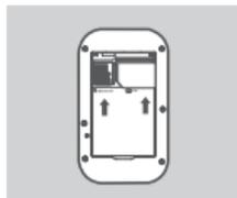
3. Skjut SIM-kortets ram till höger och lyft uppåt. Sätt i SIM/UICC-kortet i SIM/UICC-kortfacket enligt hur det visas och var noga med att guldkontaktarna är nedåt. Sätt tillbaka ramen och skjut den till vänster för att låsa den på plats.
