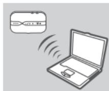
1. Χρησιμοποιήστε τον προσαρμογέα ασύρματης επικοινωνίας του υπολογιστή σας για να συνδεθείτε στο ασύρματο δίκτυο dlink\_DWR-932\_xxxx. Το όνομα του ασύρματου δικτύου (SSID) και ο κωδικός πρόσβασης αναγράφονται στην ετικέτα που βρίσκεται στο κάλυμμα της μπαταρίας.
