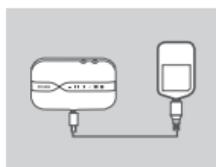
5. Συνδέστε το άκρο του καλωδίου USB με βύσμα Micro USB στη θύρα Micro USB στο κάτω μέρος του DWR-932 και το άκρο με βύσμα USB στη θύρα USB ενός τροφοδοτικού (δεν περιλαμβάνεται) ή υπολογιστή για να φορτίσετε την μπαταρία.
