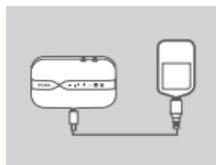
5. Schließen Sie den Micro-USB Stecker des USB-Kabels am Micro USB-Port unten am DWR-932 an und stecken Sie den USB Typ A Stecker in den USB-Port des Netzteils (nicht im Lieferumfang enthalten) oder in einen PC, um die Batterie aufzuladen.
