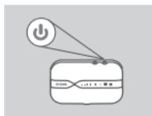
6. Mantenha premido o botão de alimentação durante três segundos para ligar o dispositivo. Quando o LED da corrente mudar de verde para âmbar ou azul fixo, pode prosseguir com a configuração.
