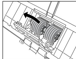
**3** Setzen Sie die neue Einzugsrolle ein.
