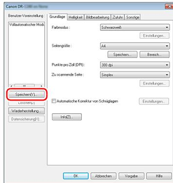
Die gespeicherte Einstellung wird in der Liste eingetragen. Sie können eine Einstellung in der Liste mit der Schaltfläche [Löschen] löschen und eine Konfigurationsdatei mit der Schaltfläche [Datensicherung] oder [Wiederherstellung] speichern bzw. laden.
