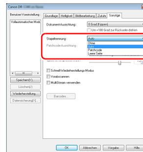
Wenn [Stapeltrennung] auf [Auto] eingestellt ist, wird der Stapel getrennt, nachdem das nächste Dokument eingelegt und der Scanvorgang fortgesetzt wurde.
