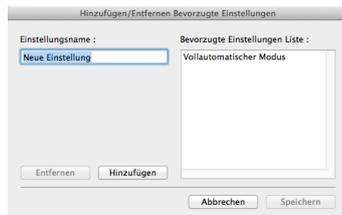
Durch Klicken auf die Schaltfläche [Hinzufügen] wird die aktuelle Einstellung unter [Bevorzugte Einstellungen Liste] gespeichert. Verwenden Sie die Schaltfläche [Entfernen] zum Löschen einer Einstellung in der Liste.
