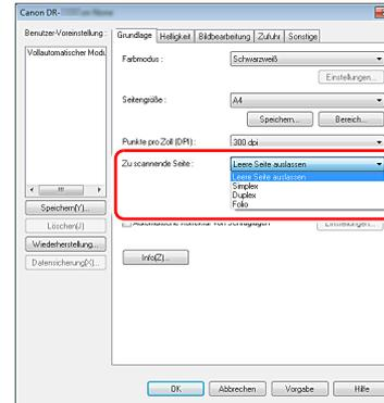
Wenn in den Einstellungen für die zu scannende Seite [Leere Seite auslassen] gewählt ist, wird die Schaltfläche [Einstellungen] aktiviert, so dass Sie mit deren Hilfe die Empfindlichkeit der Leerseitenerkennung festlegen können.
