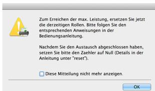
Wenn diese Mitteilung beim Starten angezeigt wird, müssen Sie einen Rollenaustauschsatz kaufen und die abgenutzten Teile durch die Verbrauchsmaterialien im Austauschsatz (Einzugsrolle und Verzögerungsrolle) ersetzen. [Siehe S. 116](#) zum Ersatzrollen-Set. Darüber hinaus muss der im Scanner befindliche Zähler, der die Anzahl der eingezogenen Seiten zählt, zurückgesetzt werden, wenn Sie die Rollen ersetzen. ([Siehe S. 116](#))
