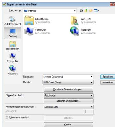
Bei Verwendung einer anderen ISIS-kompatiblen Anwendung öffnen Sie den Einstellungsbildschirm für den Scannertreiber, und wählen Sie auf der Registerkarte [Sonstige] für [Stapeltrennung] die Option [Patchcode].
