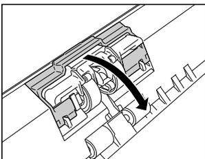
**2** Ziehen Sie am linken Verschlusshebel, der die Verzögerungsrolle am Scanner hält, und entfernen Sie die Rolle.
