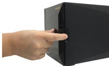
2. Ziehen Sie die Laufwerkhalterung am Riegel sanft aus dem Laufwerkschacht.
