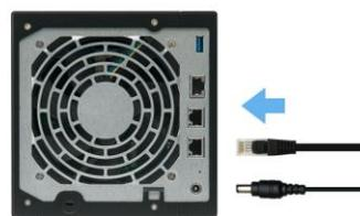
2. Verbinden Sie den NAS über ein Netzwerkkabel mit Ihrem Router, Switch oder Hub.
