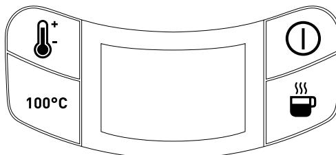
① On/Off (be/ki) gomb – A víz hőmérsékletének kijelzése a vízforralóban.
