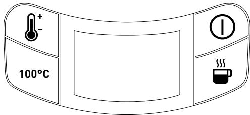
(1) Przycisk On/Off - wyświetla temperaturę wody w czajniku.
