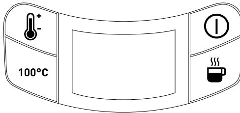
Tlačidlo zapnutia / vypnutia - zobrazenie teploty v kanvici.
