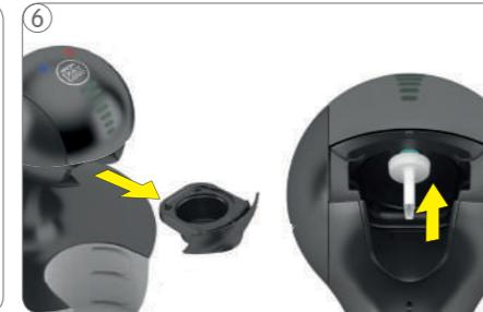
Vyjměte držák kapslí. Vstřikovací nástroj zatlačte přes vstřikovací trysku.
