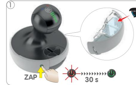
Zkontrolujte, zda je v zásobníku vody dostatek vody. Zapněte přístroj. Během zahřívání přístroje začne vypínač blikat červeně. Po přibližně 30 sekundách se vypínač rozsvítí zeleně a přístroj je připraven.
