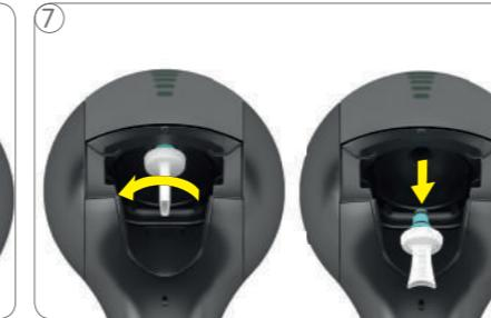
**Vstřikovací trysku vyjmějte pouze ze studeného přístroje!** Vstřikovací nástroj otočte proti směru hodinových ručiček. Vyjměte vstřikovací trysku. **Vstřikovací trysku nenechávejte bez dozoru!** **Vstřikovací trysku udržujte mimo dosah dětí!**
