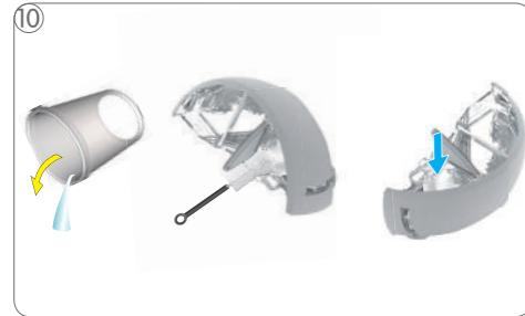
Vyprázdněte a vyčistěte nádobu. Vypláchněte a vyčistěte zásobník vody. V případě potřeby použijte čistý, biologicky bezpečný kartáč a mycí prostředek. Poté zásobník naplňte čerstvou pitnou vodou a vložte jej do přístroje.
