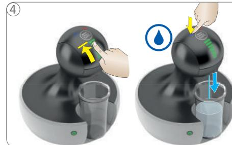
Vyplachování začněte se studenou vodou: Čárky nastavte pomocí dotykového voliče množství na max. úroveň. Stiskněte ikonu studené vody. Stroj spustí vyplachování.
