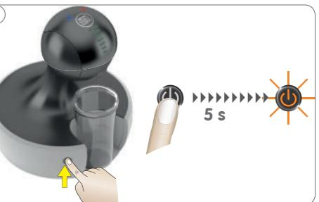
Stiskněte a přidržte vypínač po dobu alespoň 5 sekund. Vypínač začne svítit střídavě zeleně a oranžově a přístroj přejde do režimu odvápnování.
