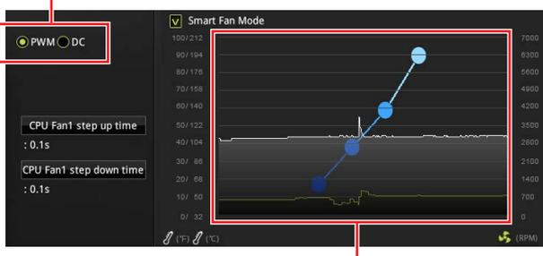
Il y a des points de gradient de la vitesse du ventilateur qui vous permet d'ajuster la vitesse de ventilateur par rapport à la température du processeur.
