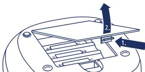
Öffnen Sie die Batterieabdeckung auf der Geräteunterseite (siehe Abb.). Setzen Sie vier Batterien des Typs AA in das Batteriefach ein. Achten Sie dabei auf die richtige Polarität (+ und -). Schließen Sie den Batteriedeckel wieder.
