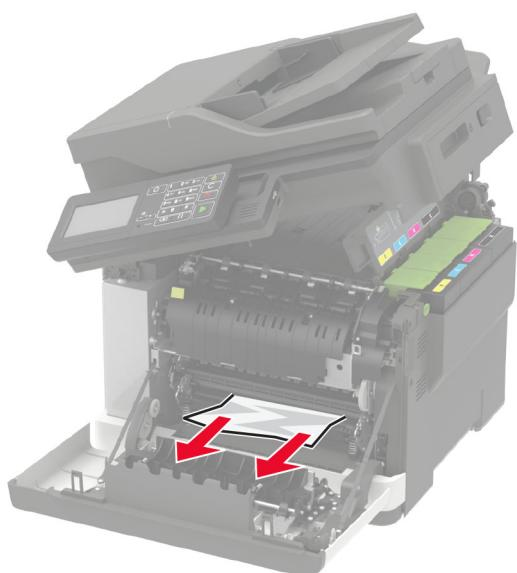
3 Otvorte prístupové dvierka fixačnej jednotky a vyberte zaseknutý papier.
