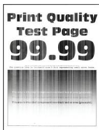
**Poznámka:** Skôr než sa pustíte do riešenia tohto problému, vytlačte strany testu kvality. V ovládacom paneli prejdite na **Nastavenia > Riešenie problémov > Strany testovania kvality tlače**. V prípade modelov
