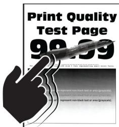
**Poznámka:** Skôr než sa pustíte do riešenia tohto problému, vytlačte strany testu kvality. V ovládacom paneli prejdite na **Nastavenia > Riešenie problémov > Strany testovania kvality tlače**. V prípade modelov tlačiarí bez dotykovnej obrazovky môžete prechádzať cez nastavenia stlačením tlačidla **OK**.
