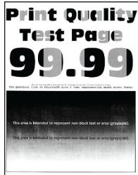
**Poznámka:** Skôr než sa pustíte do riešenia tohto problému, vytlačte strany testu kvality. V ovládacom paneli prejdite na **Nastavenia > Riešenie problémov > Strany testovania kvality tlače**. V prípade modelov tlačiarí bez dotykovnej obrazovky môžete prechádzať cez nastavenia stlačením tlačidla **OK**.
