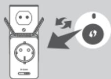
Collegare il dispositivo DAP-1365 a una presa a parete e attendere finché il LED Stato/WPS non diventa ambra lampeggiante. Premere il pulsante WPS sul router wireless o sul punto di accesso di origine, quindi premere il pulsante WPS sul dispositivo DAP-1365. Il LED Stato/WPS diventerà verde lampeggiante.
