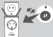
Vtaknite DAP-1365 v električno vtičnico in počakajte dokler LED lučka Status/WPS ne utripa rumeno. Pritisnite gumb WPS na izvirnem brezžičnem usmerjevalniku ali AP-ju in nato pritisnite WPS na DAP-1365. LED lučka Status/WPS bo začela utripati zeleno.
