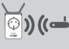
Prosimo, dovolite do dve minut, da se postopek zaključi. LED lučka Status/WPS sveti zeleno, ko je DAP-1365 uspešno povezan z izvirnim brezžičnim usmerjevalnikom ali AP-jem.
