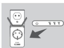
Om Signal-lysdioden lyser med en gult stav efter anslutningsproceduren har avslutats, har DAP-1365 etablerat en anslutning med dålig kvalitet. För att förbättra anslutningens kvalitet ska DAP-1365 flyttas till ett vägguttag som är närmare den trådlösa källroutern eller AP-enheten. Ju fler stavar som är tända på Signal-lysdioden, desto bättre är den trådlösa signalen.
