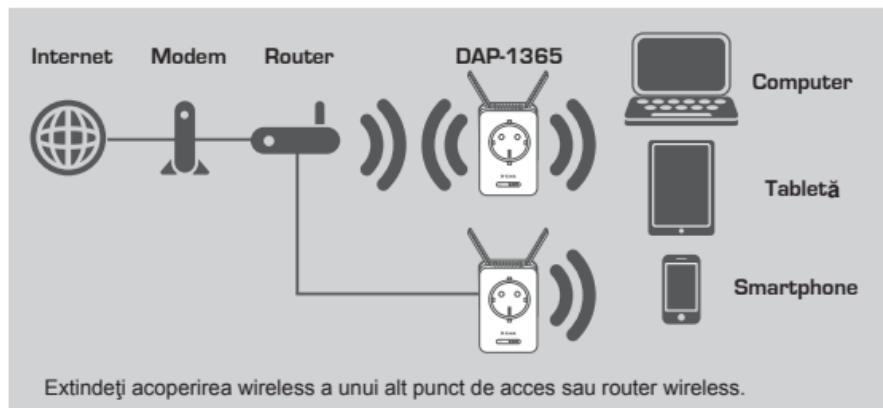
Extindeți acoperirea wireless a unui alt punct de acces sau router wireless.
