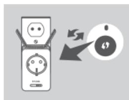
Setzen Sie den DAP-1365 in eine Wandsteckdose und warten Sie, bis die Status-/WPS-LED gelb blinkt. Drücken Sie auf dem drahtlosen Router oder AP auf die WPS-Taste und drücken Sie dann auf die WPS-Taste des DAP-1365. Die Status-/WPS-LED beginnt grün zu blinken.
