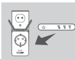
Pokud po dokončení připojení kontrolka signálu ukazuje jeden žlutý proužek, má DAP-1365 nízkou kvalitu připojení. Pro zlepšení kvality připojení přemístěte DAP-1365 do zásuvky blíže zdrojovému bezdrátovému směrovači nebo přístupovému bodu. Čím více svítících proužků na kontrolce signálu, tím je bezdrátový signál lepší.
