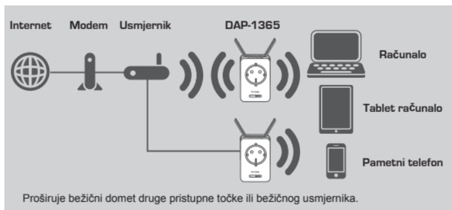
Proširuje bežični domet druge pristupne točke ili bežičnog usmjerjnika.
