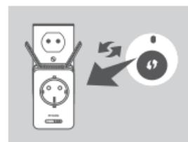
Csatlakoztassa a(z) DAP-1365 terméket egy fali aljzathoz, és várjon, amíg a Status/WPS LED jelzőfény sárgán el nem kezd villogni. Nyomja meg a WPS gombot a forrás vezeték nélküli routeren vagy hozzáférési ponton, majd nyomja meg a WPS gombot a DAP-1365 eszközön. A Status/WPS LED jelzőfény elkezd zöldön villogni.
