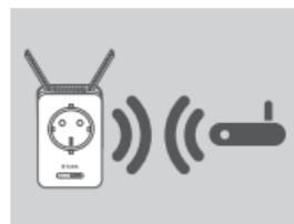
Veuillez attendre jusqu'à deux minutes jusqu'à la fin du processus de connexion. Le voyant d'alimentation reste allumé en vert lorsque le DAP-1365 s'est connecté avec succès au routeur sans fil ou point d'accès source.
