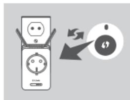
Conectați dispozitivul DAP-1365 într-o priză de perete și așteptați până când LED-ul Status/WPS (Stare/WPS) începe să clipească în culoarea galbenă. Apăsați pe butonul WPS pe punctul de acces sau routerul wireless sursă, apoi apăsați pe butonul WPS de pe dispozitivul DAP-1365. LED-ul Status/WPS (Stare/WPS) va începe să clipească în culoarea verde.
