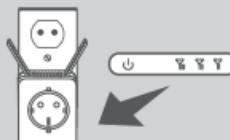
Si la señal del indicador LED tiene una sola barra en ámbar una vez finalizado el proceso de conexión, el DAP-1365 ha establecido una conexión de poca calidad. Para mejorar la calidad de la conexión, se debe cambiar la ubicación del DAP-1365 a una toma de pared más cercana al router inalámbrico o AP de origen. Cuantas más barras iluminadas haya en la señal del indicador LED, mejor será la señal inalámbrica.
