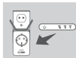
Se il LED indicatore del segnale mostra una singola barra arancione al termine del processo di connessione, il dispositivo DAP-1365 ha stabilito un collegamento di scarsa qualità. Per migliorare la qualità della connessione, spostare il dispositivo DAP-1365 in una presa a parete più vicina al router wireless o al punto di accesso di origine. Maggiore è il numero di barre illuminate sul LED indicatore del segnale e migliore sarà il segnale wireless.
