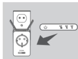
Si le voyant reste allumé en orange une fois le processus de connexion terminé, le DAP-1365 a établi une connexion de mauvaise qualité. Afin d'améliorer la qualité de la connexion, déplacez le DAP-1365 et branchez-le dans une prise murale plus proche du routeur sans fil ou point d'accès source.
