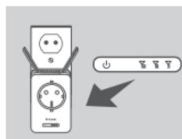
Hvis signalindikator-LED'en har en enkelt gul bjælke, efter at tilslutningsprocessen er afsluttet, har DAP-1365 etableret en forbindelse med dårlig kvalitet. For at forbedre tilslutningskvaliteten skal DAP-1365 flyttes til en stikkontakt tættere på den trådløse kilderouter eller -AP. Jo flere tændte bjælker på signalindikator-LED'en jo bedre er det trådløse signal.
