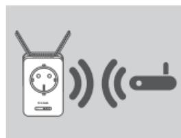
Men vent i op til to minutter på, at processen afsluttes. Status/WPS-LED'en vil skifte til konstant grønt, når DAP-1365 er korrekt tilsluttet den anvendte, trådløse router eller det anvendte, trådløse AP.
