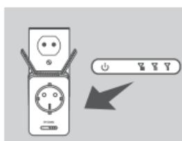
Jeśli po nawiązaniu połączenia dioda LED wskaźnika sygnału świeci się na pomarańczowo, oznacza to, że jakość połączenia urządzenia DAP-1365 z siecią jest niska. Aby poprawić jakość połączenia, urządzenie DAP-1365 należy umieścić w gnieździe elektrycznym znajdującym się w pobliżu routera Wi-Fi lub punktu dostępu. Im więcej pasków świeci się w diodzie LED wskaźnika sygnału, tym mocniejszy jest sygnał sieci bezprzewodowej.
