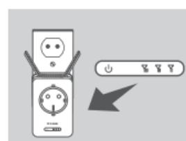
Ha a Jelerősség LED lámpa egy sárga sávval világít a csatlakozási folyamat befejezte után, akkor a DAP-1365 csak gyenge minőségű kapcsolatot hozott létre. A csatlakozás minőségének javításához a DAP-1365 termékkel olyan fali aljzatba kell áthelyezni, amely közelebb található a forrásként működő vezetékmentes routerhez vagy hozzáférési ponthoz. Minél több sáv világít a jelerősség LED lámpán a vezetékmentes jel minősége annál jobb.
