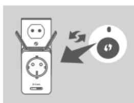
Podłącz urządzenie DAP-1365 do gniazdką sieci elektrycznej i poczekaj, aż dioda LED stanu/WPS zacznie migać na pomarańczowo. Naciśnij przycisk WPS na routerze bezprzewodowym lub punkcie dostępu, a następnie naciśnij przycisk WPS na urządzeniu DAP-1365. Dioda LED stanu/WPS powinna zacząć migać na zielono.
