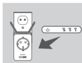
Se o LED Indicador de Sinal tiver uma única barra âmbar após terminar o processo de ligação, o DAP-1365 estabeleceu uma ligação de fraca qualidade. Para melhorar a qualidade da ligação, o DAP-1365 deve ser mudado para uma tomada de parede mais próxima do router ou do PA sem fios de origem. Quanto mais barras estiverem acesas no LED Indicador de Sinal, melhor será o sinal sem fios.
