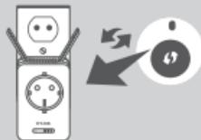
Enchufe el DAP-1365 en una toma de pared y espere hasta que el LED de estado/WPS parpadee en ámbar. Pulse el botón WPS en el router inalámbrico o AP de origen y, a continuación, pulse el botón WPS en el DAP-1365. El LED de estado/WPS empezará a parpadear en verde.
