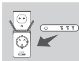
Dacă LED-ul Signal Indicator (Indicator semnal) are aprinsă o singură bară galbenă după realizarea conexiunii, înseamnă că dispozitivul DAP-1365 a stabilit o conexiune de slabă calitate. Pentru a îmbunătăți calitatea conexiunii, dispozitivul DAP-1365 trebuie reposiționat și conectat la o priză de perete aflată mai aproape de routerul wireless sau punctul de acces sursă. Cu cât există mai multe bare aprinse ale LED-ului Signal Indicator (Indicator semnal), cu atât semnalul wireless este mai bun.
