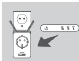
Zeigt die Signalanzeige-LED einen einzigen gelben Balken an, nachdem der Verbindvorgang abgeschlossen wurde, hat der DAP-1365 eine Verbindung minderer Qualität hergestellt. Um die Verbindungsqualität zu verbessern, sollte der DAP-1365 an einer Wandsteckdose angeschlossen werden, die näher am drahtlosen Router oder AP ist. Je mehr Balken auf der Signalanzeige-LED leuchten umso besser ist die Qualität des drahtlosen Signals.
