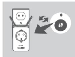
Ligue o DAP-1365 a uma tomada de parede e aguarde até que o LED Status/WPS pisque a âmbar. Pressione o botão WPS no router sem fios de origem ou no PA e, em seguida, pressione o botão WPS no DAP-1365. O LED Status/WPS começará a piscar a verde.
