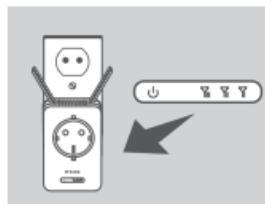
Hvis signalindikator-LED-en har en enkelt gul stripe etter at tilkoblingen er ferdig, har DAP-1365 etablert en tilkobling med dårlig kvalitet. For å forbedre tilkoblingens kvalitet, bør DAP-1365 bli flyttet til et stikkontakt nærmere den trådløse kilderuter eller AP. Jo flere lyse striper på signalindikator-LED-en, desto bedre det trådløse signalet.
