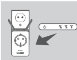
Indien het signaalindicatorlampje een enkele oranje balk heeft nadat het verbindingsproces is voltooid, heeft de DAP-1365 een verbinding van slechte kwaliteit vastgesteld. Om de verbindingskwaliteit te verbeteren, moet de DAP-1365 dichter bij een wandstopcontact geplaatst worden, dichter bij de bron draadloze router of AP. Hoe meer balken verlicht zijn op het signaalindicator-lampje, hoe beter het draadloze signaal.
