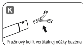
Pružinový kolík vertikálnej nôžky bazéna
