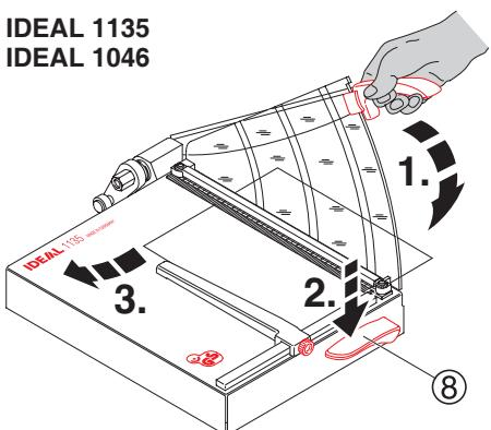
**DE** Dann das Papier mit der Handpressung ② pressen und den Schnitt ausführen (bei den Modellen IDEAL 1135 und IDEAL 1046 erfolgt die Pressung automatisch bei Schnittausführung).
