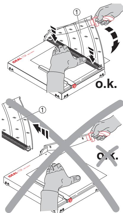
**DE** Bei allen Maschinentypen darf der Messerschutz ① nicht abgenommen werden und muß jederzeit funktionsfähig sein.
