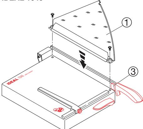
**DE** Vor Inbetriebnahme muß die Preßvorrichtung mit dem daran befestigten Messerschutz ① montiert werden. Dazu die Preßvorrichtung mit Messerschutz ① aufsetzen (der Messerschutz muß dabei hinter der Messerschutz-führung ③ parallel zum Messer justiert werden).
