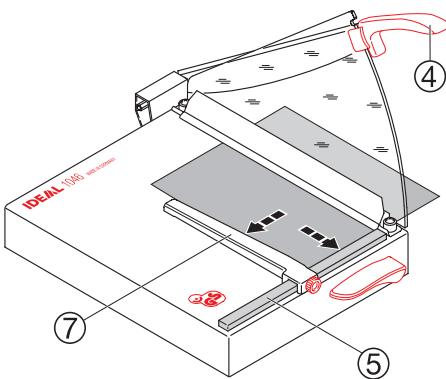
**DE** Messerhebel ④ anheben und Papier einlegen. Rückanschlag ⑦ und Seitenanschlag ⑤ ermöglichen eine präzise Papieranlage
