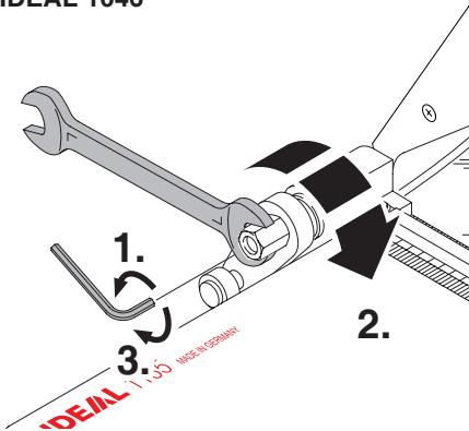
**ES** La máquina tiene un **sistema de fricción** en el portacuchillas. Este asegura que el portacuchillas no se pueda mover hacia abajo solo. Si el portacuchillas no está en su posición y se mueve solo, por favor reajustar el sistema de fricción inmediatamente.
