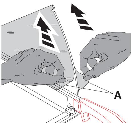
**NL** Voor ingebruikname dient de papieraandruker met de mesbeschermer ① gemonteerd te worden. Om dit te doen de mesbeschermer ① op de tafel van de bordschaar plaatsen (de mesbeschermer dient achter de geleiding ③ te vallen parallel met het mes). Vervolgens vastzetten met de 2 meegeleverde kruiskop (+wasmachines IDEAL 1134) schroeven (zie afbeelding). Bij modellen IDEAL 1046, dient de beschermfolie (A) van de mesbeschermer te worden verwijderd.
