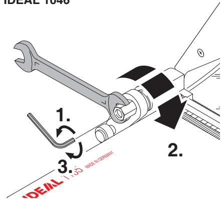
**NL** De machine is uitgerust met een **frictievoorziening** aan de meshouder. Deze zorgt ervoor dat de meshouder niet uit zichzelf neerwaarts beweegt. Indien dit toch het geval is, dan dient de frictievoorziening als volgt te worden nagesteld:
