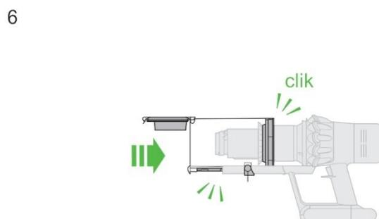
Průhlednou nádobu na prach zavřete tak, že zatlačíte její dno nahoru, dokud průhledná nádoba na prach a dno nádoby nezaklapnou.
