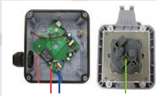
2. Schließen Sie die heißen, neutralen und Erdungskabel entsprechend an.
