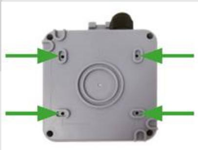
1. Bearbeitung von 4 mm Löchern in der Mitte der ovalen Nut und 6 mm Loch in der Wand. Spreizhülsen in die Wand einsetzen.
