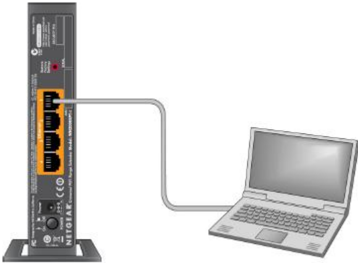
Obrázek 3. Připojení extenderu k počítači
