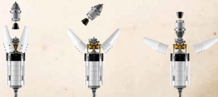
El módulo de control/auxiliar (MCA) se separa del adaptador
