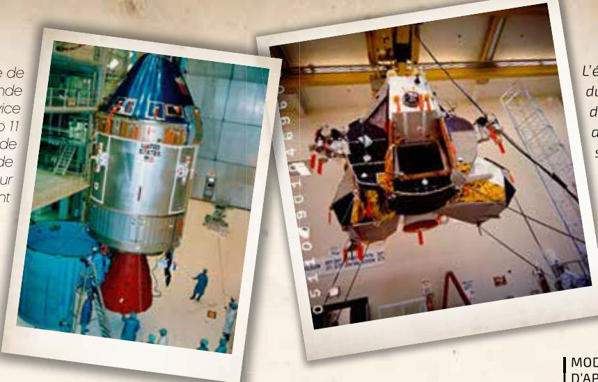
L'étage de remontée du module lunaire dans la zone d'assemblage final, soulevé par un palan
