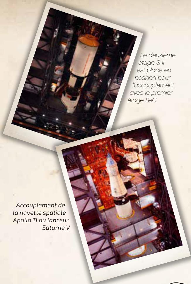
Le deuxième étage S-II est placé en position pour l'accouplement avec le premier étage S-IC
