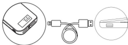
Schließen Sie die Powerbank über den USB-Port, mit dem mitgelieferten USB- auf Micro-USB-Kabel, an Ihren Computer an.
