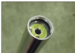
Felfüggesztés merevségét beállító csavar
