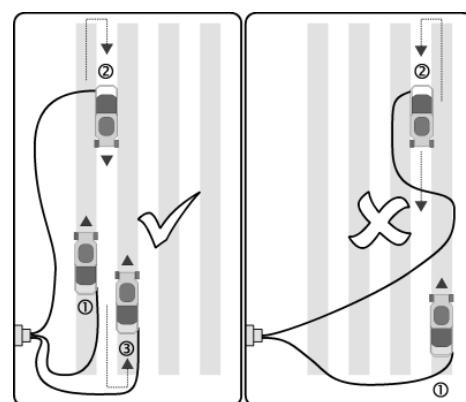
**Varování:** Nepostupujte směrem ke kabelu, jak je znázorněno na obrázku vpravo.
