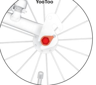
L'attaccamento inferiore, all'opposto, permette, regolare il sellino in più alto del normale. **Attenzione:** dopo ogni cambiamento di posizione della ruota posteriore bisogna risistemare i freni!
