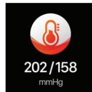
Krvný tlak: Hodinky meria krvný tlak užívateľa pod týmto zhraním. Údaje o krvnom tlaku sú merané po dobu 25 sekúnd a obrazovka sa automaticky vypne po 75 sekundách.
