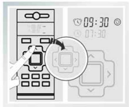
**BEACHTEN!** Stellen Sie sicher, dass Sie die Uhr und den Zeitplan zurücksetzen, nachdem Sie die Batterie des Controllers gewechselt haben.
