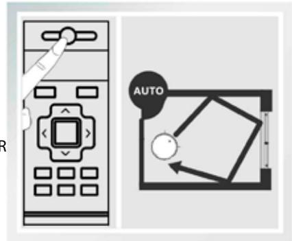
**TIPP:** Der Roboter setzt seinen Reinigungsplan zurück, wenn er den Reinigungsmodus oder die Reinigungsrichtung ändert. Für ein besseres Ergebnis lassen Sie es bitte alleine arbeiten.
