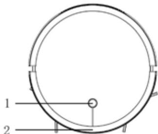
1. Netzschalter / START-STOP-Taste + LED-Steuerung
