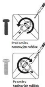
Wenn Sie den Propeller austauschen müssen, lösen Sie die Schraube am Propeller A mit einem Schraubendreher im Uhrzeigersinn. Lösen Sie die Schraube gegen den Uhrzeigersinn, um die Schraube am Propeller B zu entfernen.
