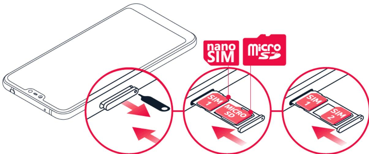
1. Öffnen Sie das SIM- und Speicherkartenfach: Setzen Sie den Öffnerstift in die Vertiefung des Fachs und ziehen Sie das Fach heraus.
