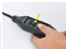
4. Stlačte tlačidlo «RESET», kontrolka sa rozsvieti na červeno. Prúdový chránič funguje.
