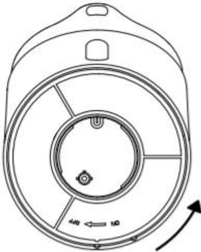
1. Öffnen Sie die Batterieabdeckung gegen den Uhrzeigersinn.
