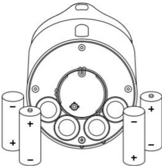
2. Setzen Sie die Batterie gemäß den am Batterieanschluss angegebenen Polaritäten (+/-) richtig ein.
