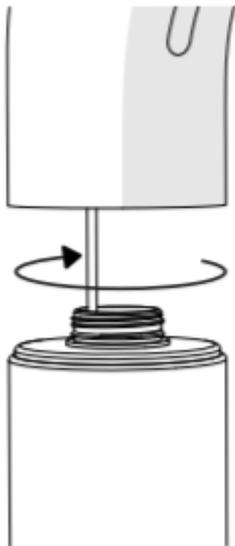
6. Richten Sie den Desinfektionsmittelbehälter am Boden des Produkts aus und drehen Sie ihn gegen den Uhrzeigersinn, bis er fest sitzt.
