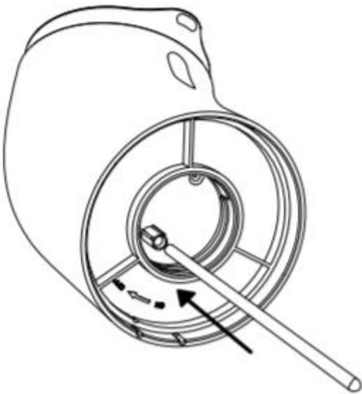
4. Entfernen Sie die Desinfektionspumpe aus dem Zubehör und setzen Sie die Saugöffnung der Waschmaschine ein.
