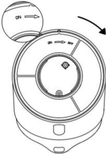
3. Richten Sie die Entriegelungsmarkierung an der Batterieabdeckung auf das zylindrische Loch an der Seite des Produkts aus, drehen Sie die Batterieabdeckung im Uhrzeigersinn, um sie zu sichern, und richten Sie sie an der zylindrischen Bohrung aus.
