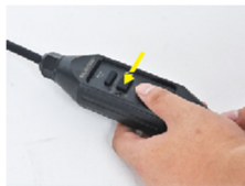
2. Nyomja meg a RESET gombot, a jelzőfény pirosra vált.
